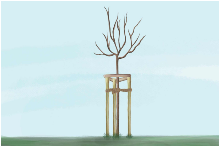
Abbildung 1: Anbindung des Baums mit Variante Dreibein
